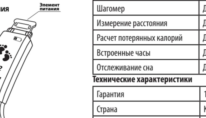
Элемент питания расположен на противоположной от кнопки включения стороне.
